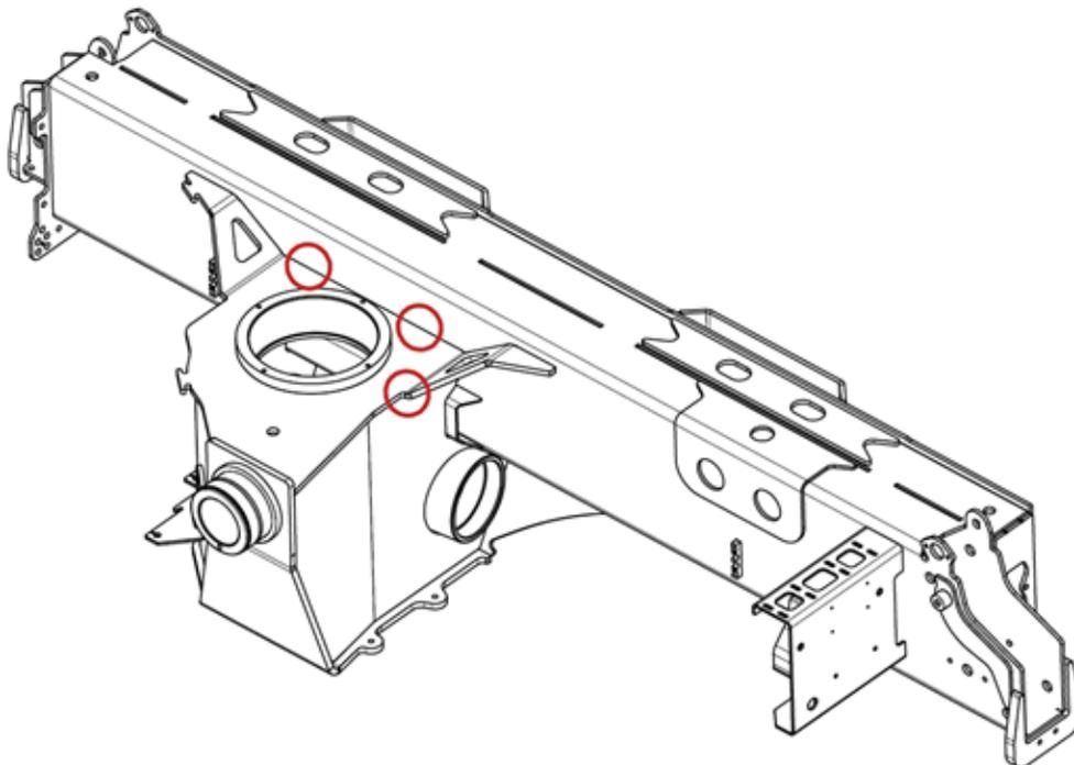
Durante las inspecciones de servicio regulares se deben comprobar ambos lados del vehículo y debajo de la base de la grúa, usando una luz muy fuerte.
